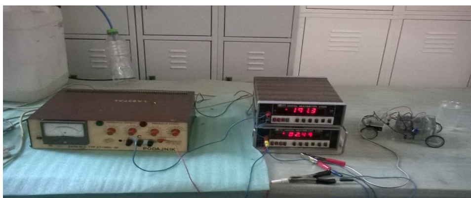
Rys.4. Stanowisko badawcze- mini-pojazd, zasilacz, mierniki napięcia i natężenia.
